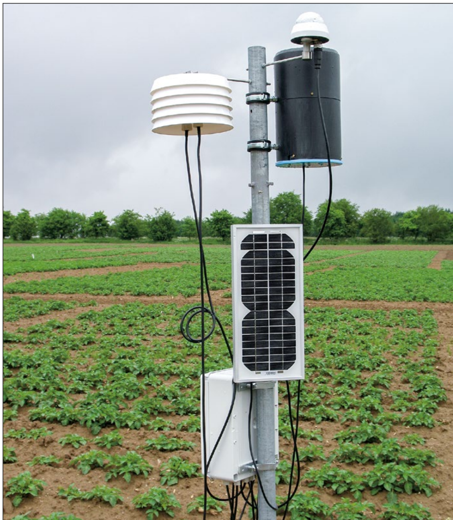
Obr. 14: Automatická meteorologická stanice pro sledování prognózy
