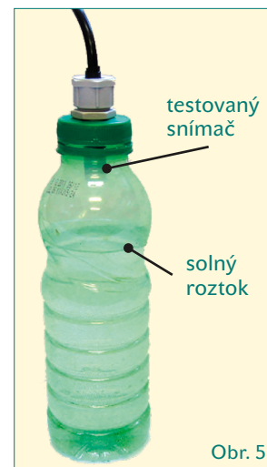
Obr. 5: Ukázka jednoduchého způsobu kalibrace vlhkostního senzoru před jeho umístěním do výsadby
