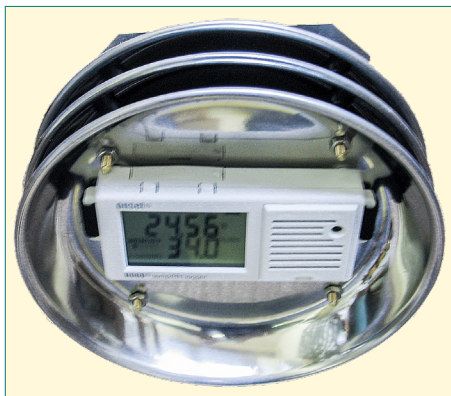
Obr. 4: Registrátor teploty a vlhkosti vzduchu umístěný v nerezovém stínítku
