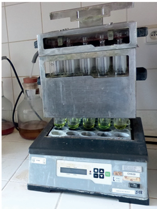
Obr. 9. Mineralizace vzorků filet na přístroji KjelROC Digestor 20, stanovení bílkovin (Foto: L. Schebestová).
