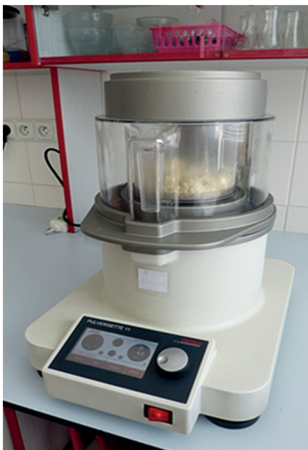
Obr. 5. Homogenizace vzorků filet, nožový mlýn Pulverisette 11 (Foto: L. Schebestová).
