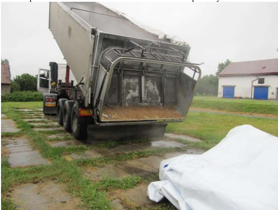
Obr. 4 Aplikační zařízení na korbě nákladního automobilu pro uchycení vaku.
