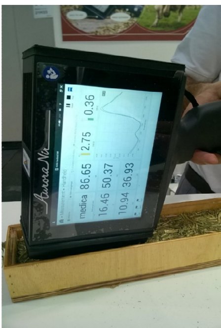
Foto 6 a 7: Detail přístroje RCI AuroraNir (vlevo) a práce s ním (vpravo)
