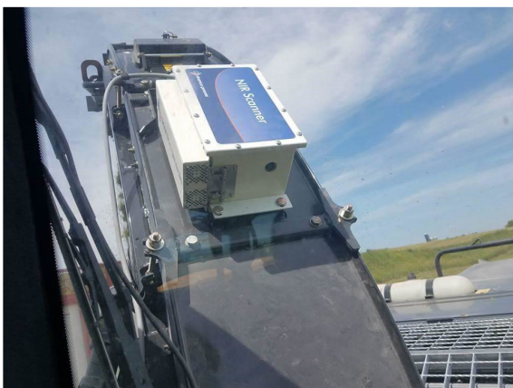
Foto 3 a 4: Přístroj NIR On Board (vlevo) a řídicí jednotka k přístroji NIR On Board (vpravo)
