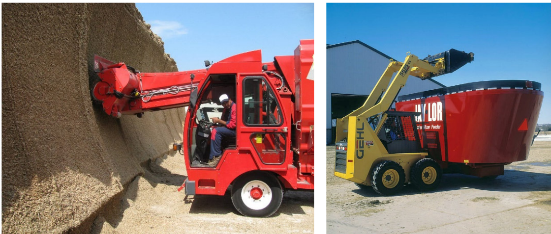
Foto 16 a 17: Nir On Board na fréze krmeného vozu (vlevo) a na krmeném voze (vpravo)
