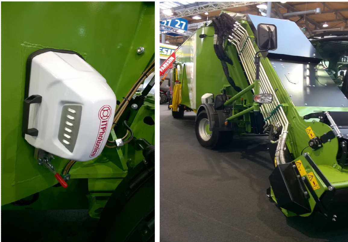
Foto 8 a 9: Detail přístroje ITPhotonics (vlevo) a jeho umístění na krmném voze (vpravo)
