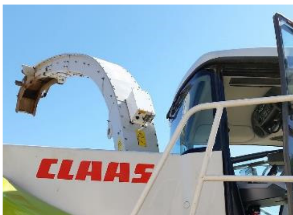
Foto 5 a 6: HarvestLab na řezačce John Deere (vlevo) a NIR On Board na řezačce Claas (vpravo)
