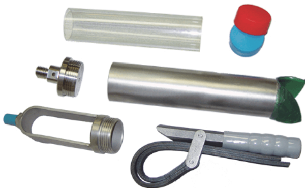
Obr. 6 - Trubice s pístem pro odběr sedimentů.
