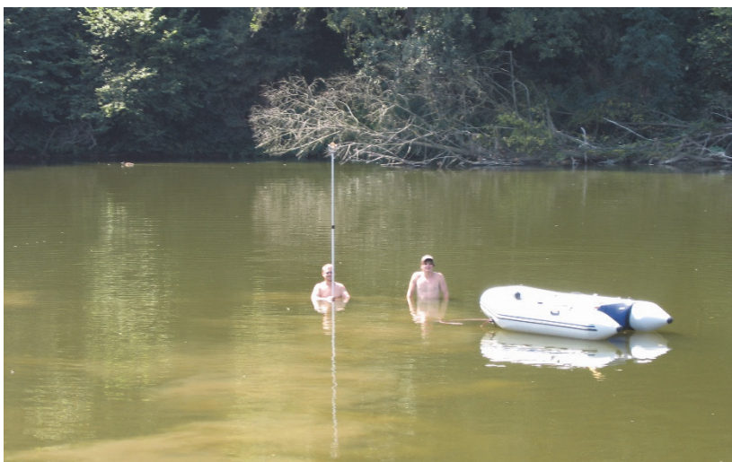
Obr. 24 – Měření geodetickou polární metodou – napuštěný rybník.
