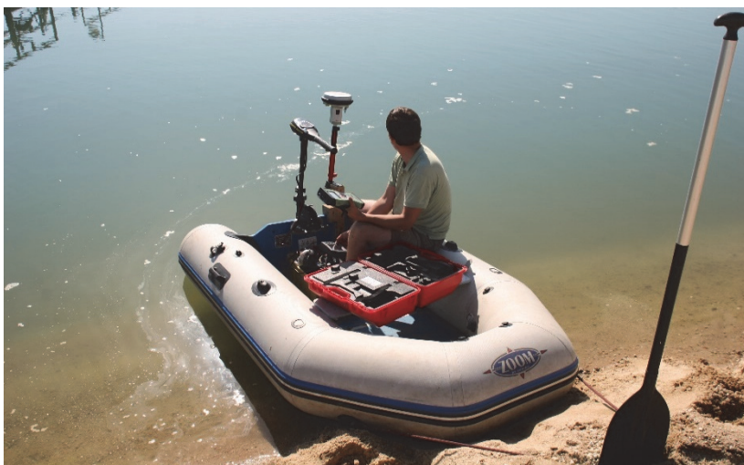
Obr. 20 – Měřická sonarová sestava připravena na sběr dat.
