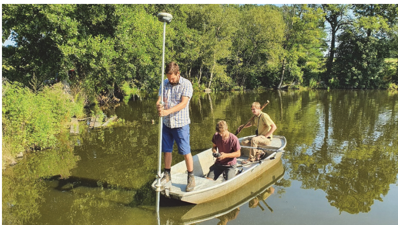
Obr. 26 – Měření aparaturou pro kvantifikaci množství sedimentu.
