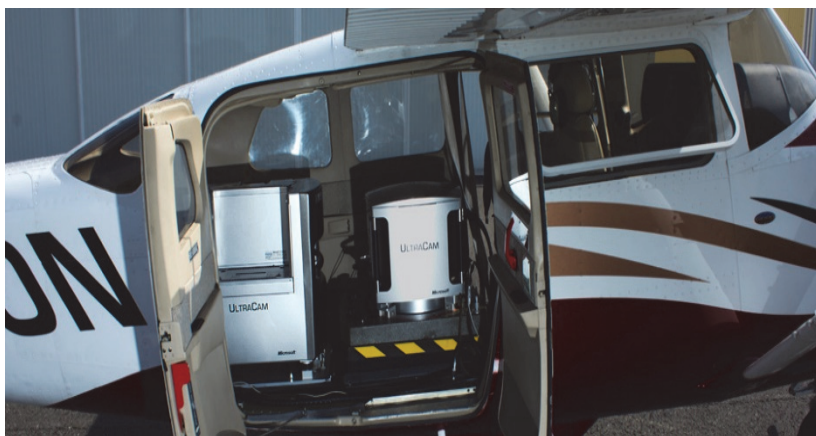
Obr. 18 – Speciálně upravený letoun pro provádění LMS a LLS.
