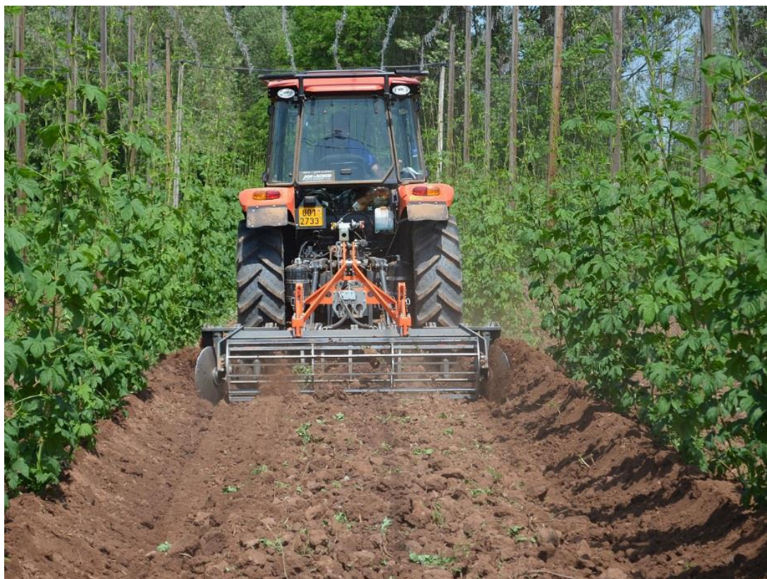
Obr. 6: Traktor s přiorávacími disky během přiorávky řadů
