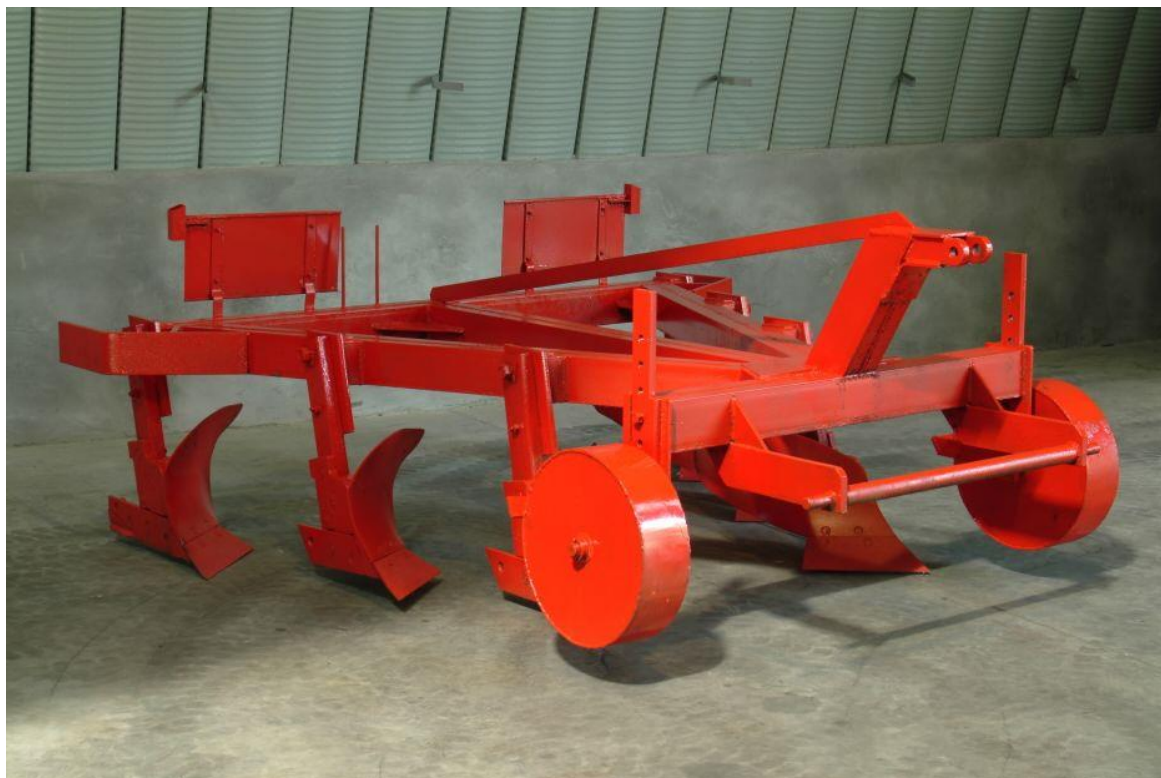
Obr. 7: Oboustranný přiorávací pluh 1
