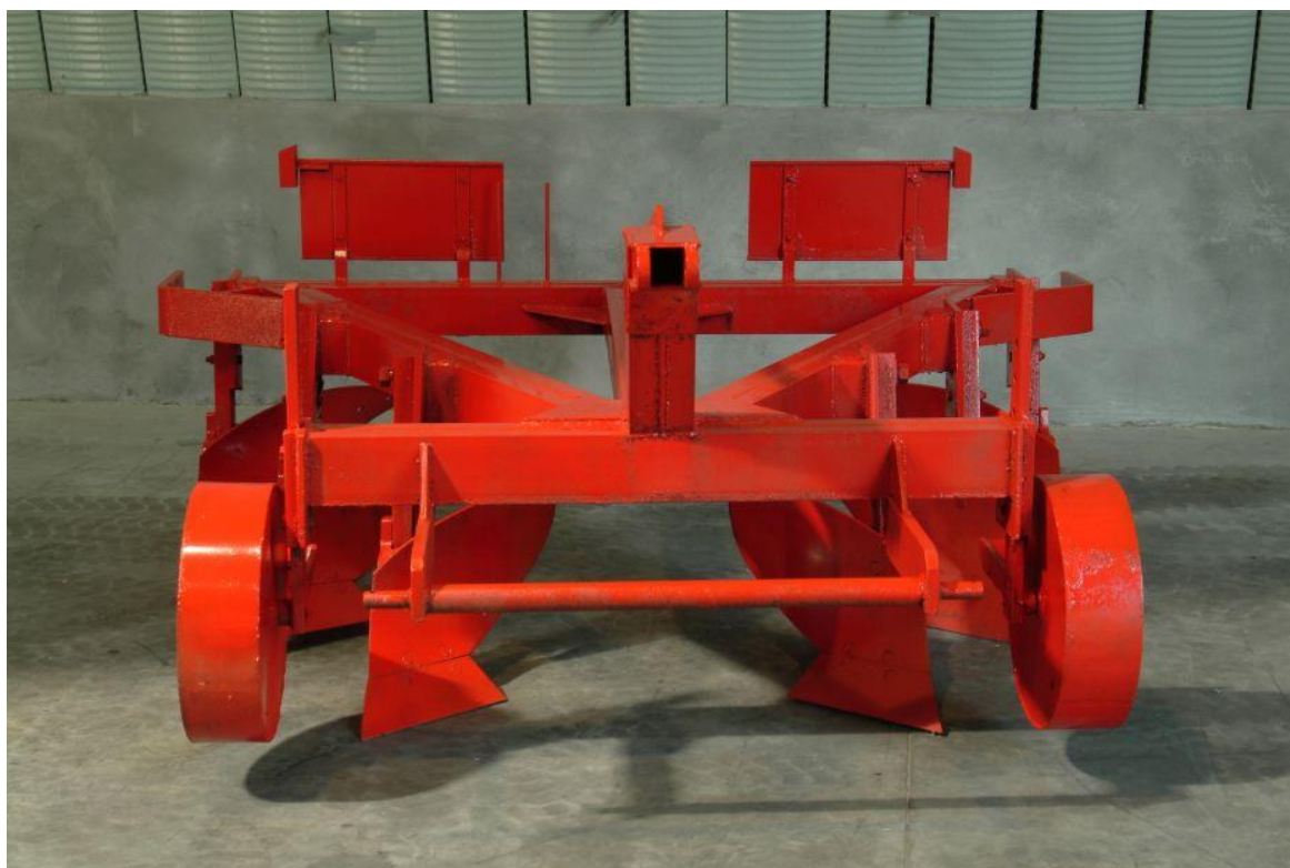
Obr. 8: Oboustranný přiorávací pluh 2
