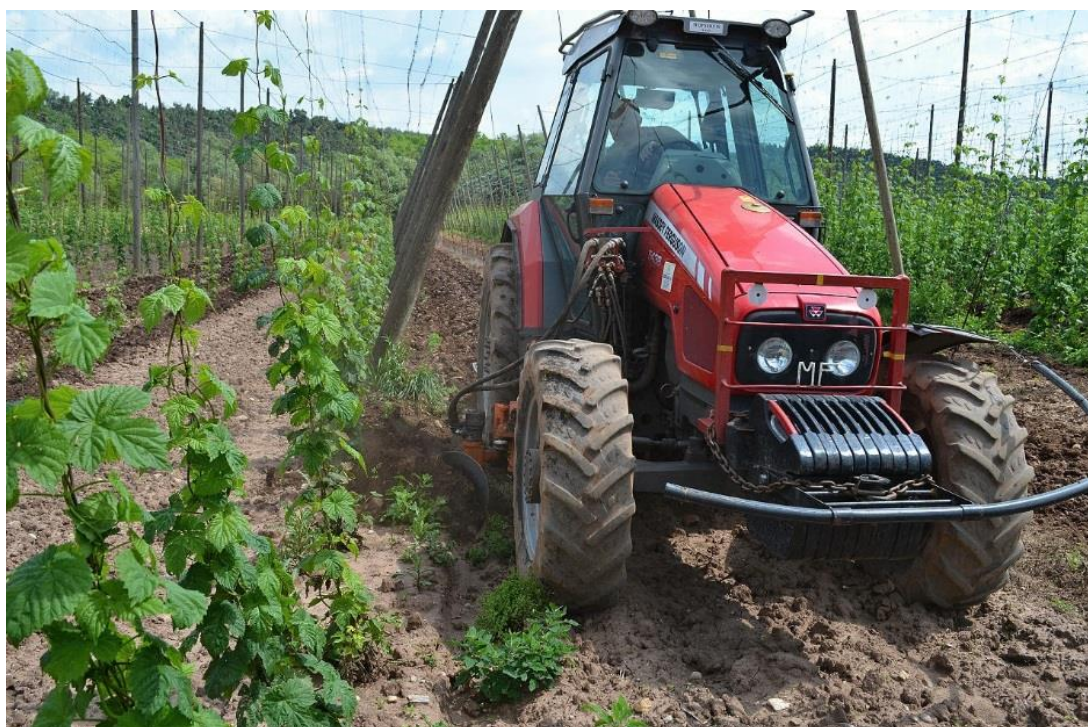
Obr. 5: Traktor s mezinápravovým diskem provádějící přiorávku řadů
