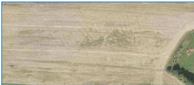
Obr. 47 Ukázka identifikace skutečného průběhu a umístění odvodňovacích systémů na LMS – ortofoto (zdroj mapy.cz)
