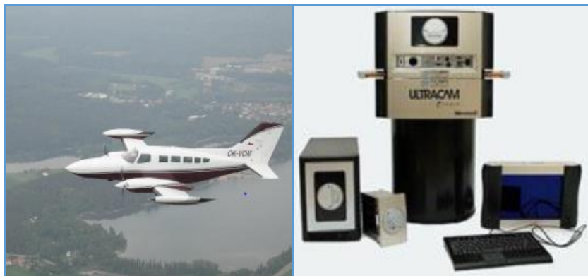
Obr. 8: Příklad využitelného leteckého nosiče CESSNA 402B a letecký měřicí systém kamera Vexcel UltraCAM Eagle
