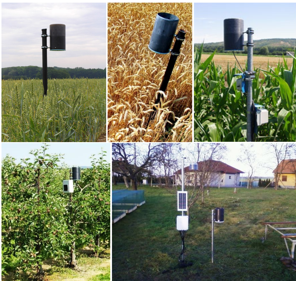
Obr. 1 Ukázka umístění srážkoměru v zemědělských experimentech
