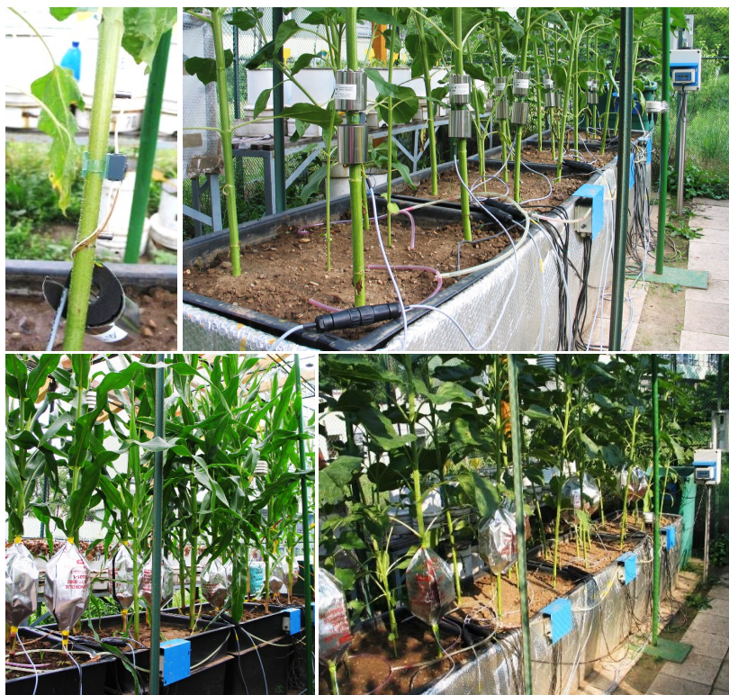
Obr. 25 Instalace senzorů pro měření transpirace prostřednictvím monitoringu toku xylémové šťávy (SHB metoda) v experimentu se slunečnicí – nahoře; monitoring sap flow v experimentu s kukuřicí (dole vlevo) a v experimentu se slunečnicí (dole vpravo)
