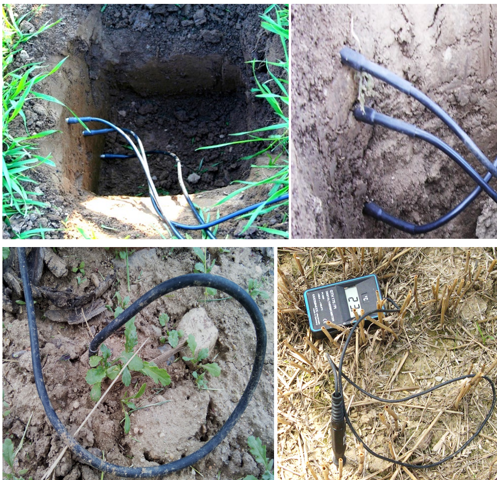
Obr. 28 Elektrické půdní teploměry a jejich umístění v půdním profilu (nahore); měření teploty půdy v povrchové vrstvě (v hloubce 2–3 cm) – dole vlevo; měření okamžité teploty půdy vpichovací sondou (dole vpravo)
