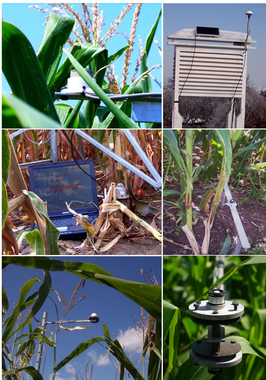
Obr. 39 Zařízení na měření intenzity slunečního záření různé konstrukce a účelu sledování v zemědělských experimentech
