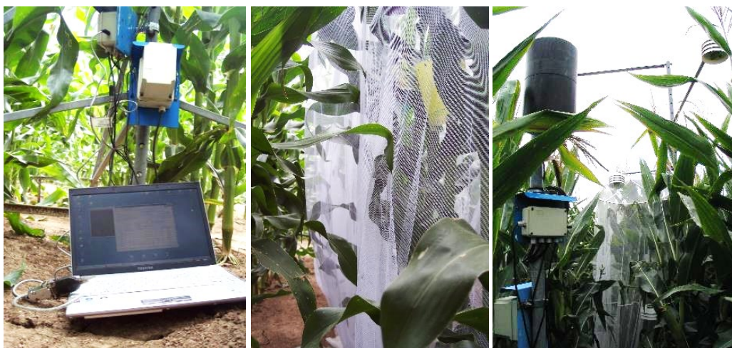
Obr. 30 Příklad monitoringu mikroklimatu porostu a půdního klimatu pro účely precizního specifikování nároků škodlivého činitele s využitím lapačů a izolátoru Zdroj: autoři
