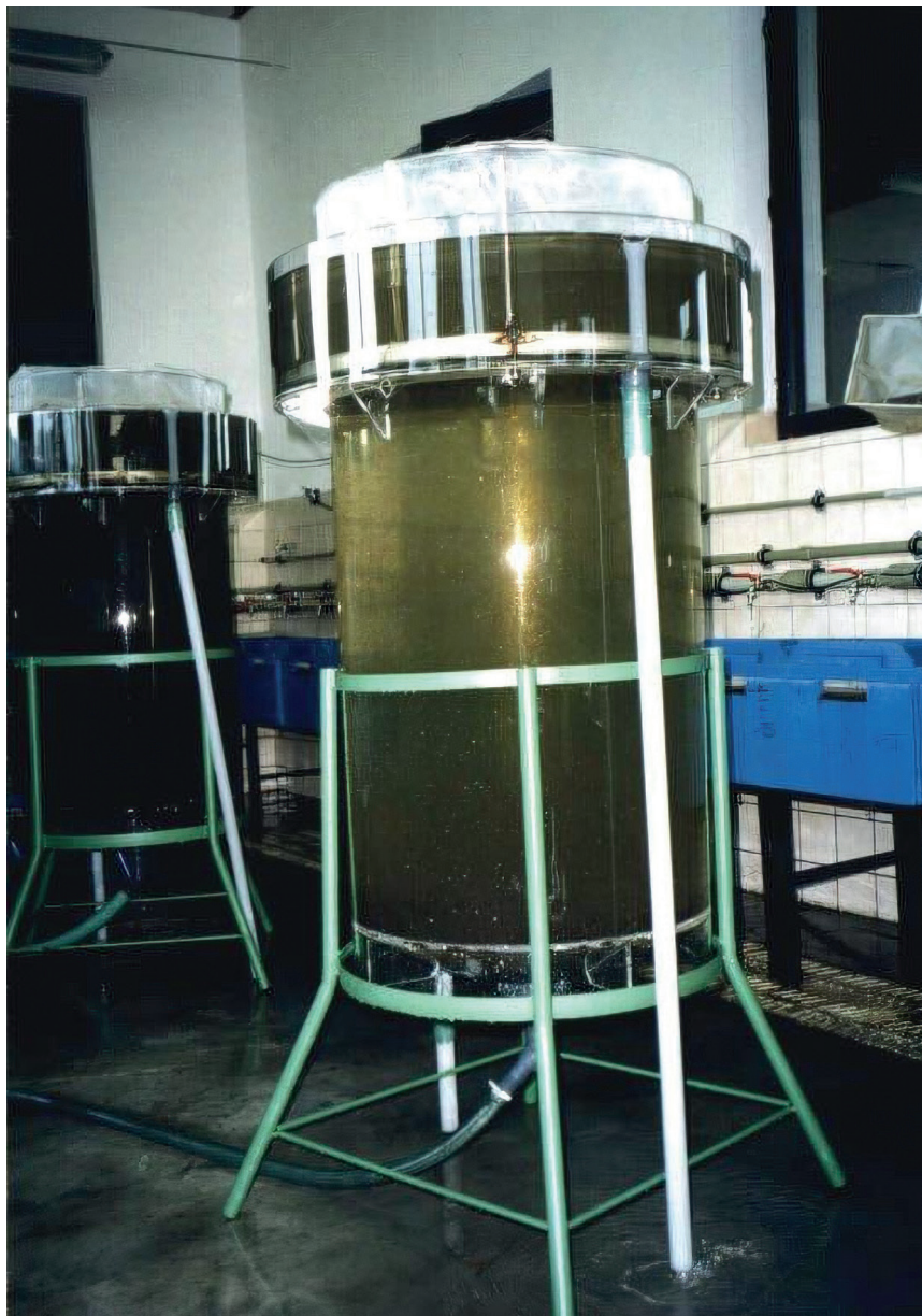
Obr. 30. Inkubační přístroj pro jikry býložravých ryb, používaný také pro rozplavání plůdku kapra obecného (foto D. Gela).
