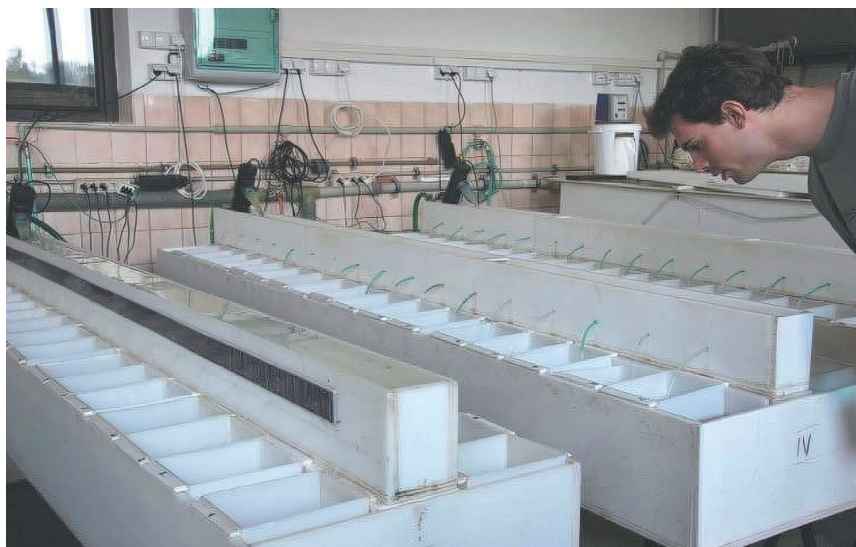
Obr. 14. Experimentální inkubátor s recirkulovanou vodou ošetřenou UV zářením pro inkubaci jiker při optimalizaci způsobu oplození (foto V. Kašpar).
