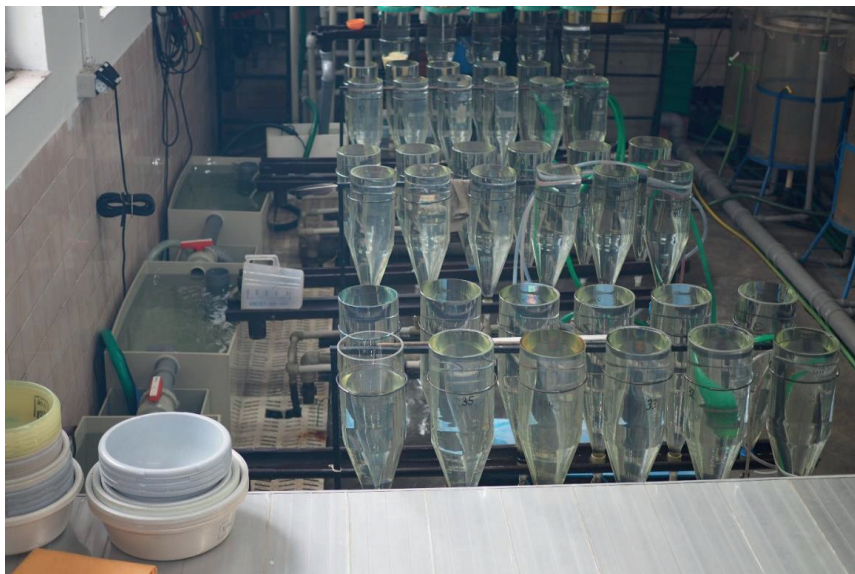
Obr. 24. Recirkulační rybí líheň připravená pro umělou reprodukci kapra (foto V. Kašpar).
