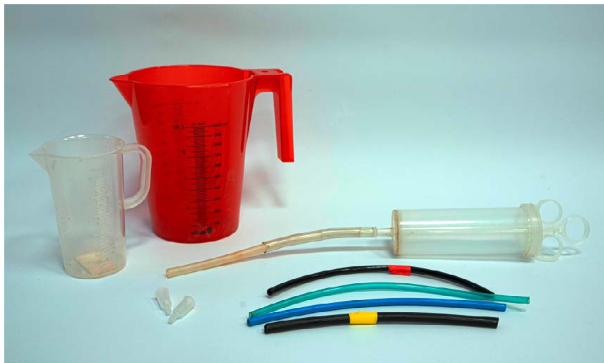
Obr. 1. Stříkačka Janett o objemu 150ml a sada katetrů použitých při testování této metodiky na kapru obecném. Nálevky různé velikosti pro zachycování vytékajícího obsahu zažívacího traktu kapra (Foto J. Škrabánek).
