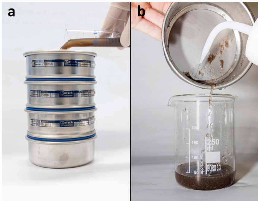
Obr. 6. Soustava kovových sít s velikostí ok 2 000, 1 000 a 100 \mu\text{m} , které slouží k oddělení předkládané potravy od zbytku přirozené potravy a zároveň k odmytí jemného sedimentu (a). Převádění frakce 100 \mu\text{m} do kádinky pro další zpracování pod mikroskopem (b) (Foto M. Bláha).
