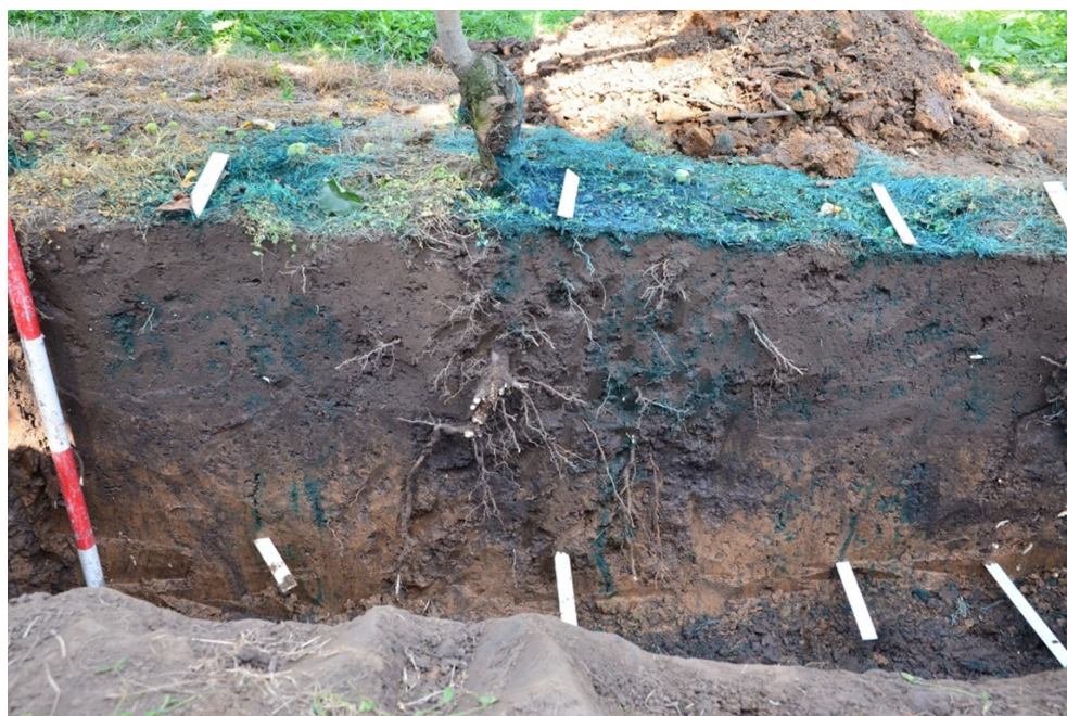
Obrázek 32. Zobrazení půdního profilu a provlžení kořenové zóny vodou smíchanou s potravinářským barvivem. Bílé jmenovky na povrchu půdy označují rozmístění kapkovačů. Spodní řada jmenovek označuje hloubku půdy ve 30 cm, jak je patrné s přiložené trasírkou.
