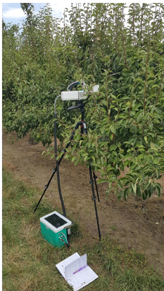
Obrázek 18. Měření průduchové vodivosti, fotosyntézy a transpirace infračerveným analyzátozem plynů (LI-6800)
