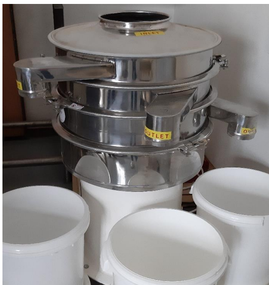
a) Vibrační třídič S49-600-3S s možností osazení třemi sítý o průměru 600 mm
