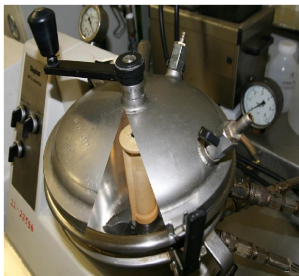
Obr. 11: Laboratorní kondicionace provedená na průmyslovém výrobníku Stephan UM/SK5, semena byla kondicionována přímým vstřikem páry (1,5–2,0 bar) (Foto: J. Kyselka)
