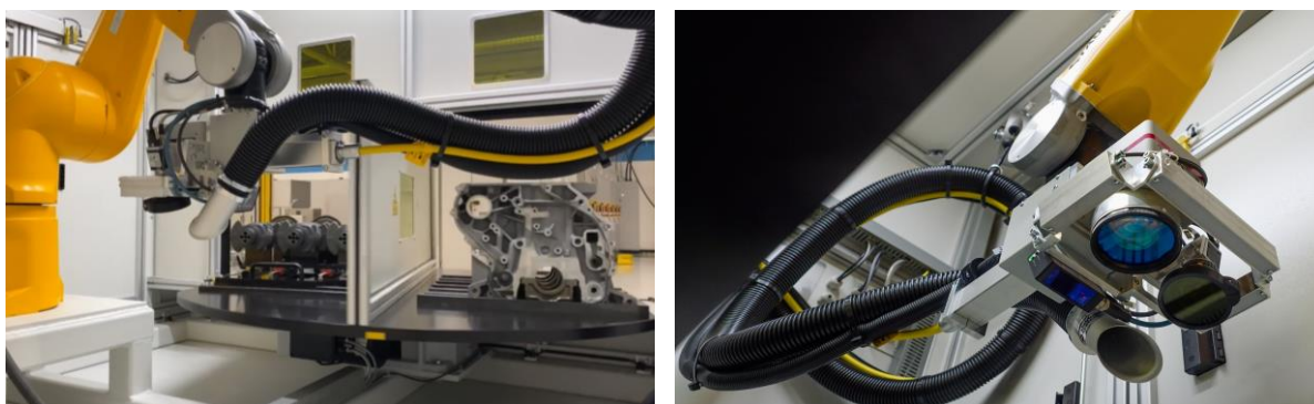
Obrázek 8. a Obrázek 9. Robotické pracoviště pro přeznačování dílů
