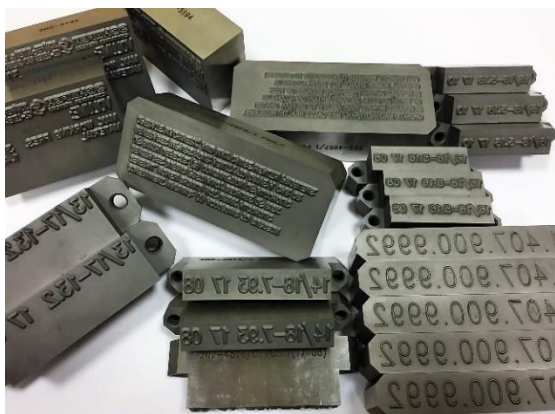
Obrázek 4. a Obrázek 5. Ukázky razníků, které jsou vyráběny na zakázku podle potřeby zákazníka
