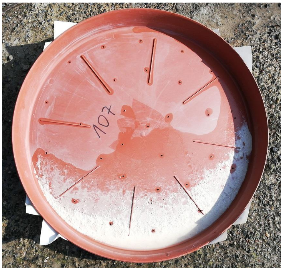
Obrázek 9: Upravená odběrová nádoba pro kontrolu úplnosti zásahu
