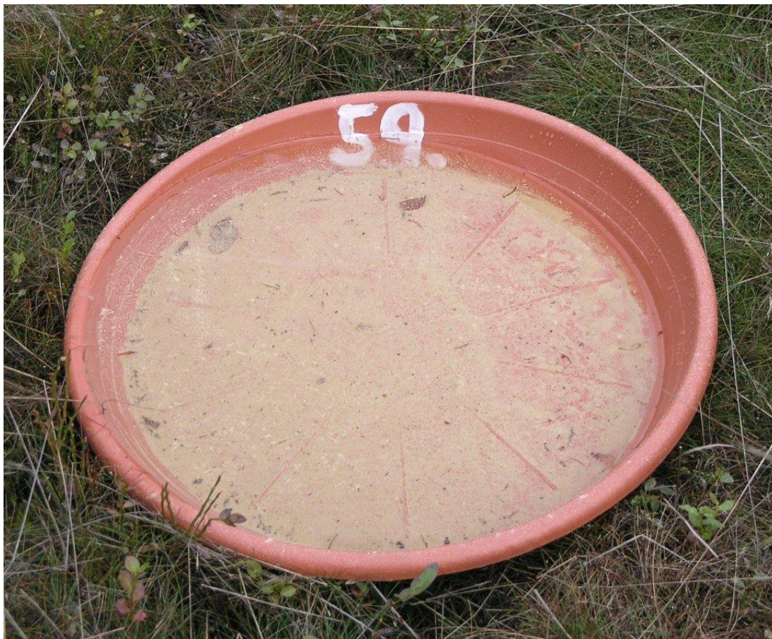
Obrázek 7: Kontrolní nádoba částečně vymytá srážkami
