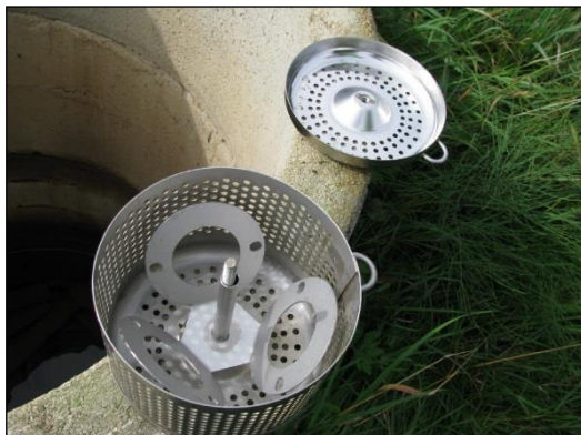
Obr. č. 3: Vzorkovač POCIS / držák vzorkovačů POCIS (průměr 10 cm, tloušťka 0,6 cm)
