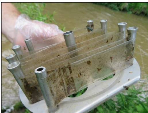
Obr. č. 2: Držák semipermeabilní membrány (výška 5 cm, průměr 15 cm)
