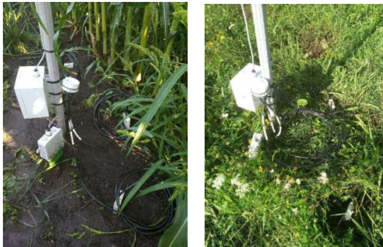
Obr. 4.31: Instalace 3 ks referenčních senzorů Campbell CS-655 pro měření půdní objemové vlhkosti na půdním typu černozem a kambizem.
