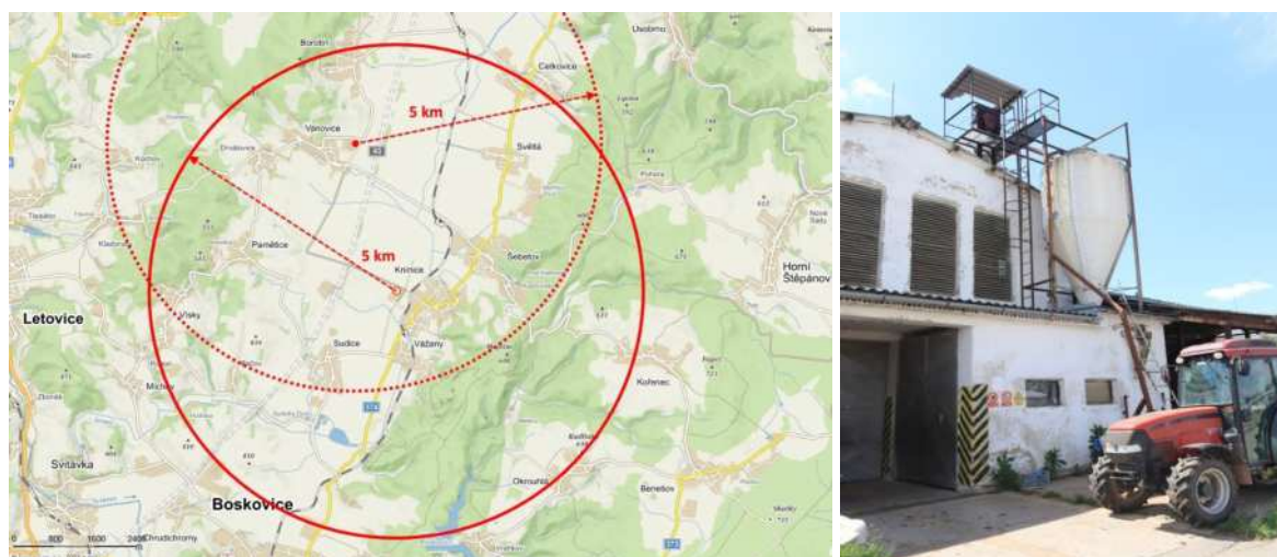
Obr. 4.19: Předpokládané pokrytí sítě LoRaWAN modelového území ze základnové stanice ve středisku Knínice (plná čára) a pokrytí z druhé základnové stanice (záložní) ve středisku Vanovice (čárkovaně).
