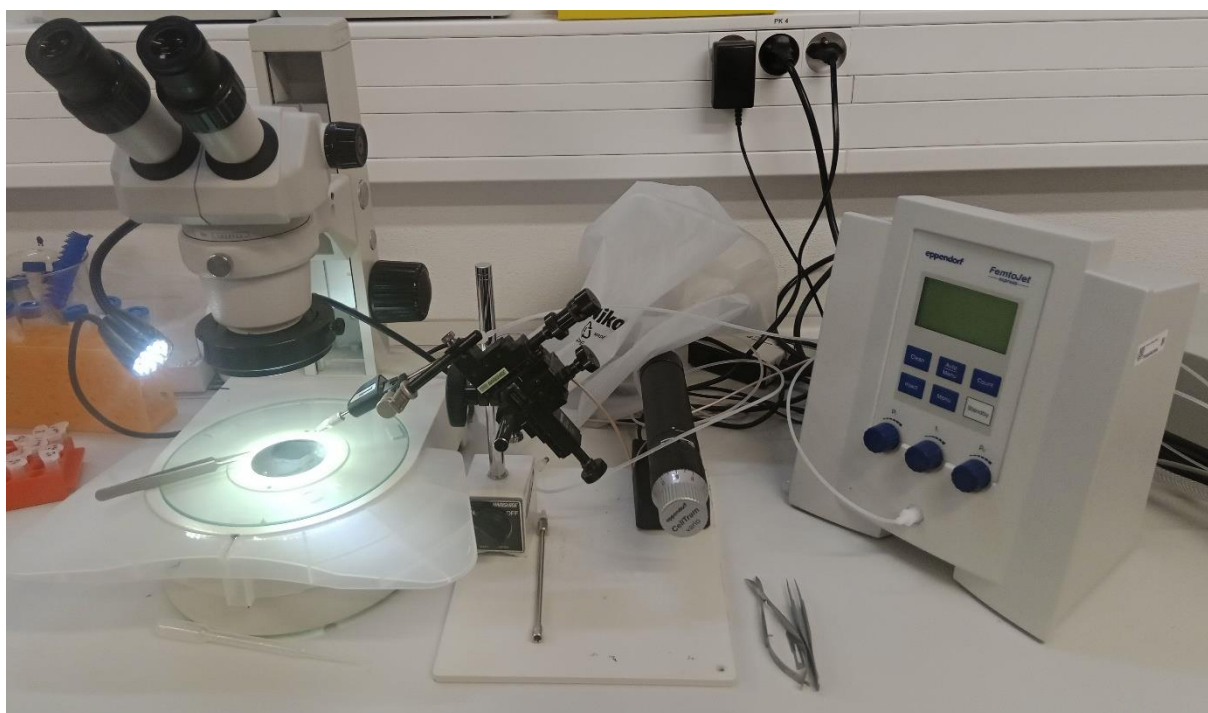
Obr. 8. : Stereomikroskop Nikon, mikroinjektor Narishige a pneumatický injektor Femtojet 4i používaný k transplantaci zárodečných buněk (Foto: R. Franěk).
