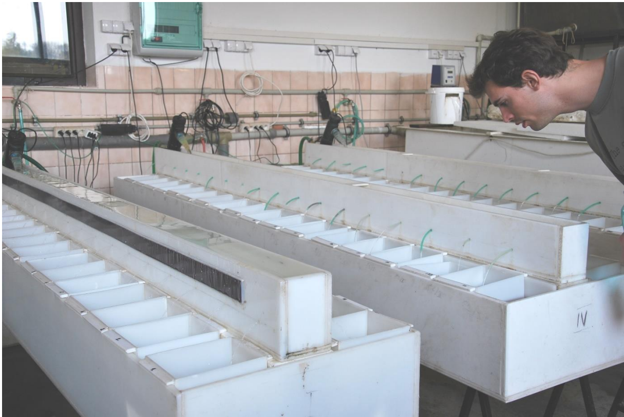
Obr. 3.: Experimentální inkubátor s recirkulovanou vodou ošetřenou UV zářením pro inkubaci jiker karasa po mikroinjekci nebo inkubace jiker z experimentálních oplození (Foto: V. Kašpar).
