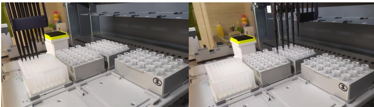
Obrázek č. 3 „PLATE creating“ v robotickém zařízení TECAN EVO Freedom
