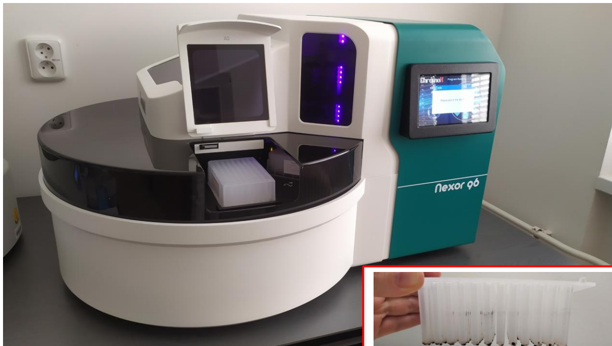
Obrázek č. 6 Izolátor NEXOR96, detail magnetických prstů s rezidui magnetických partikulí
