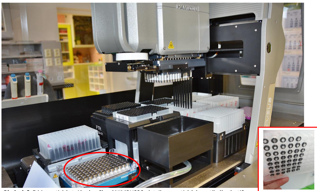
Obrázek č. 5 Magnetický stojánek zařízení NIMBUS96, detail magnetických partikulí v destičce
