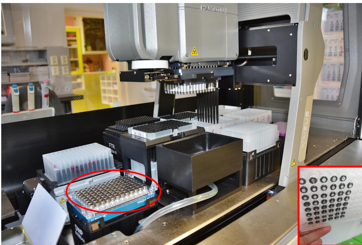
Obrázek 7. Magnetický stojánek v zařízení NIMBUS96, detail magnetických partikulí v destičce
