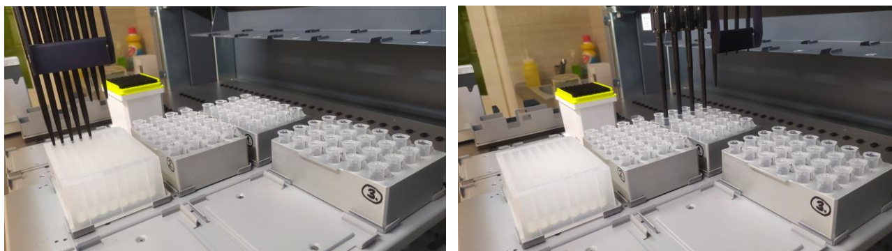
Obrázek 4. a Obrázek 5. „PLATE creating“ v robotickém zařízení TECAN EVO Freedom
