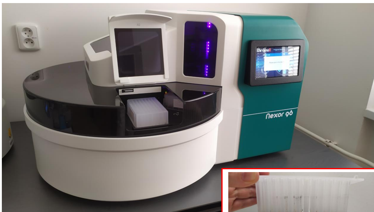
Obrázek 8. a Obrázek 9. Izolátor NEXOR96, detail magnetických prstů s rezidui magnetických partikulí
