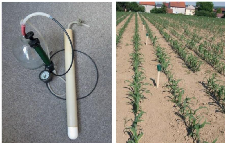
Obr. č. 12: Ukázka sukčního kelímku s vakuovou pumpičkou a jeho umístění na lokalitě (Fučík, Zajíček et al. 2017)
