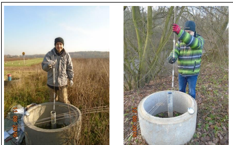
Obr. č. 18: Instalace a deinstalace pasivních dozimetrů do monitorovacího vrtu
