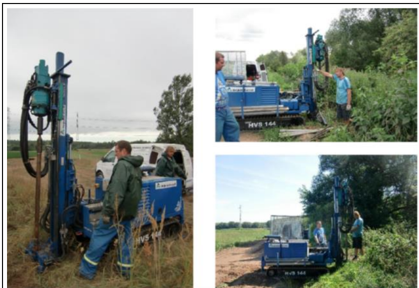
Obr. č. 15: Vrtná souprava HVS 144 při budování monitorovacích vrtů na lokalitě Tuřice
