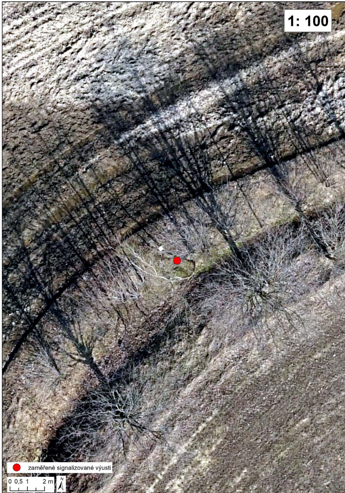
Obr. 20 Výřez ortofota s jednoznačně identifikovatelným označníkem a bodovou vrstvou evidovaných zaměřených výustí v řešené lokalitě, 2,5 cm/px, 19. 3. 2020 v měřítku 1: 100 (zdroj: Geodézie Východní Čechy)
