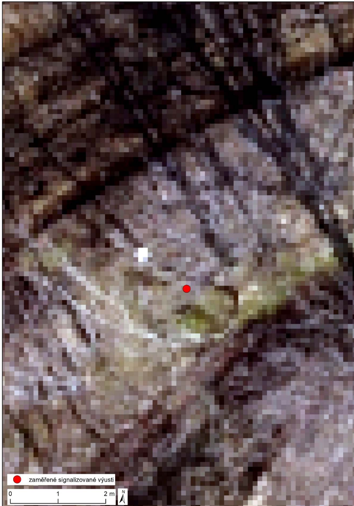
Obr. 22 Výřez ortofota s jednoznačně identifikovatelným označníkem a bodovou vrstvou evidovaných zaměřených výustí v řešené lokalitě, 10 cm/px, 19. 3. 2020 (zdroj: Geodézie Východní Čechy)
