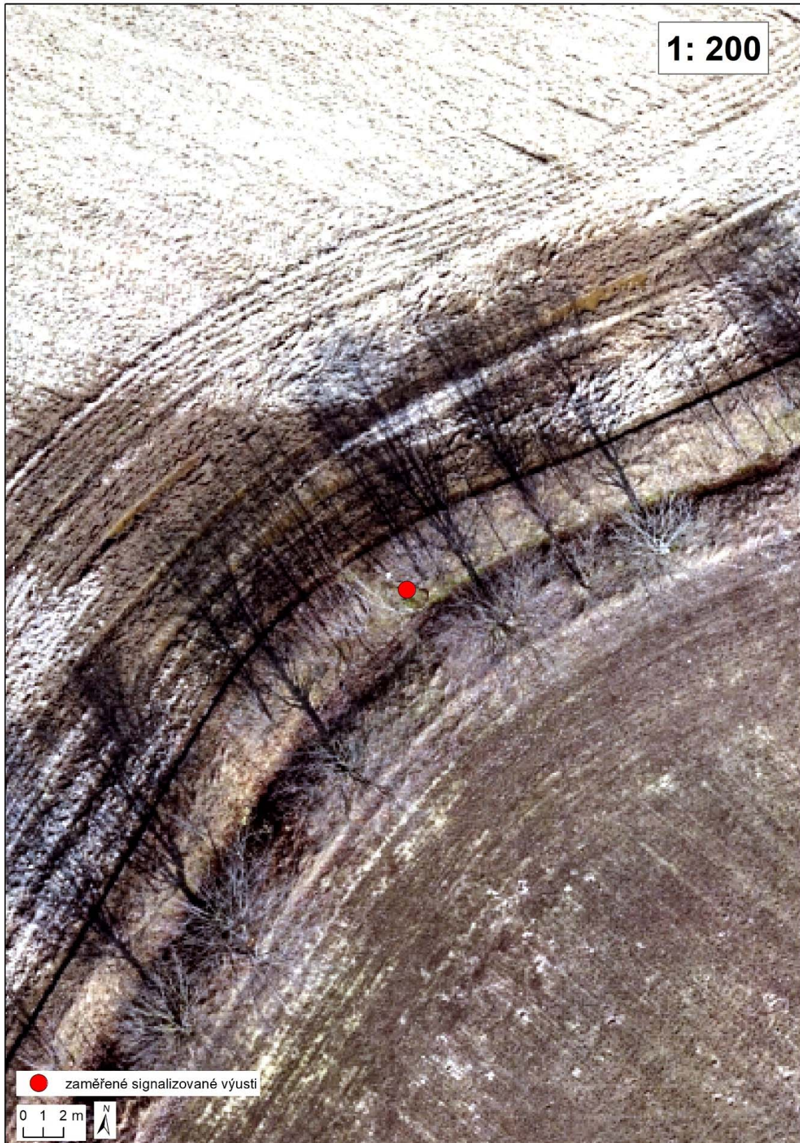
Obr. 24 Výřez ortofota s jednoznačně identifikovatelným označníkem a bodovou vrstvou evidovaných zaměřených výustí v řešené lokalitě, 10 cm/px, 19. 3. 2020 v měřítku 1: 200 (zdroj: Geodézie Východní Čechy)
