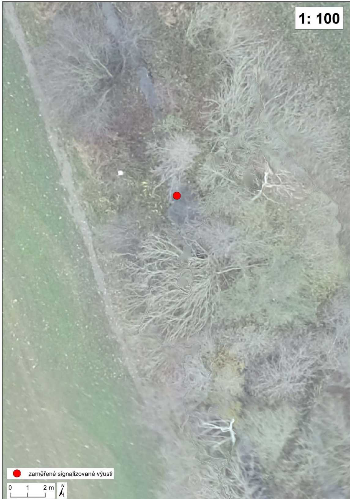
Obr. 25 Výřez ortofota s jednoznačně identifikovatelným označníkem a bodovou vrstvou evidovaných zaměřených výustí v řešené lokalitě, 3,8 cm/px, 26. 11. 2020 v měřítku 1: 100 (zdroj: Upvision)
