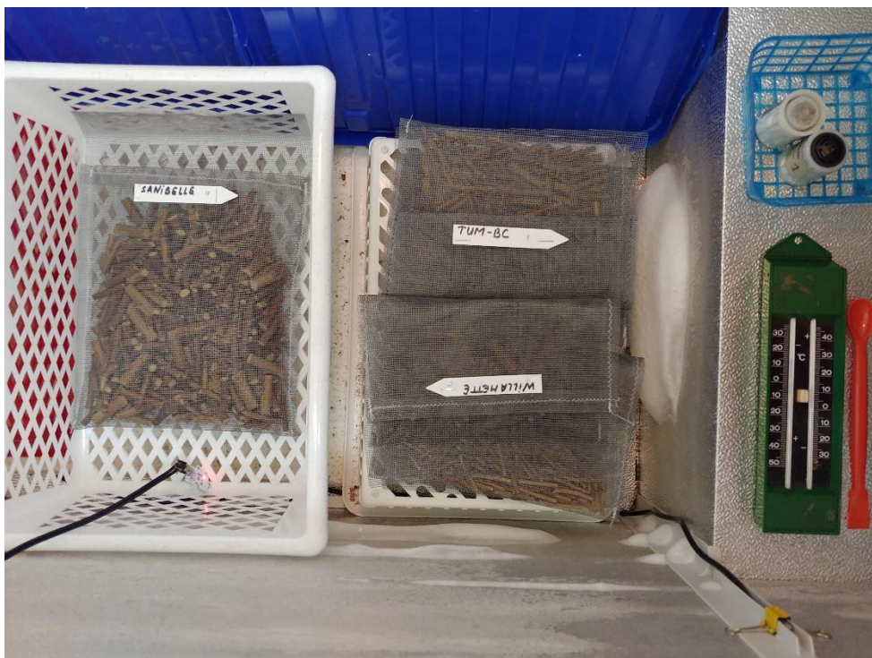
Obrázek 2. Síťky s jednonodálními segmenty dormantních pupenů maliníku v košíku v mrazicím boxu pro mrazovou dehydrataci při teplotě -4 °C.
