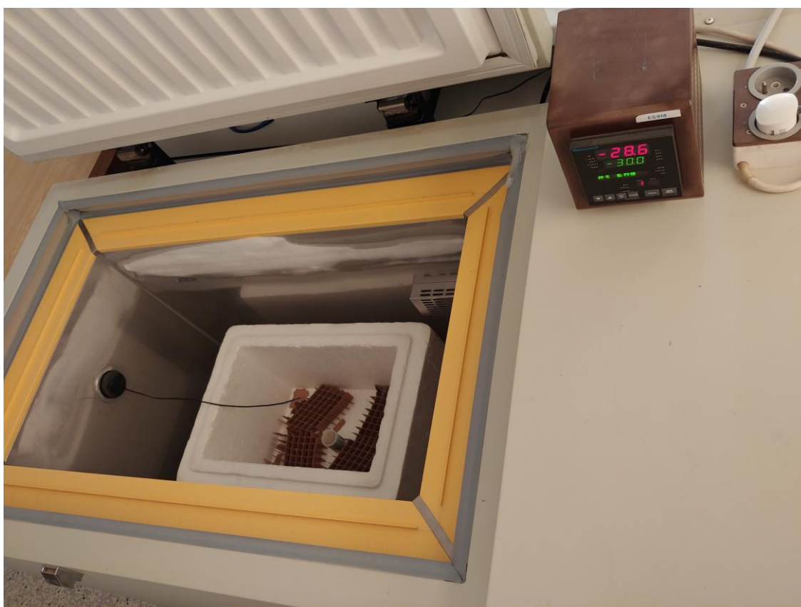
Obrázek 4. Laboratorně upravený programově řízený mrazicí box pro regulované snižování teploty pro dvoustupňový kryoprezervační protokol.
