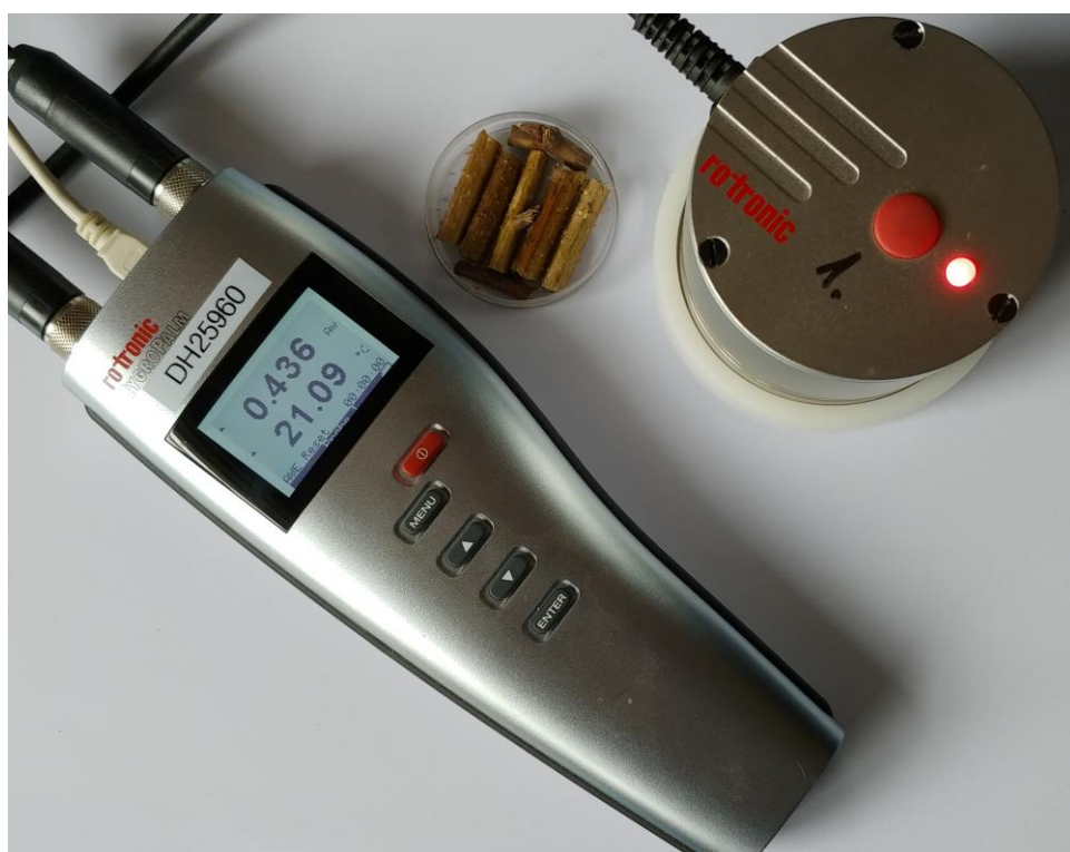
Obrázek 3. Měření aktivity vody dormantních pupenů maliníku pomocí přístroje Water Activity Meter HP23-AW (Rotronic).
