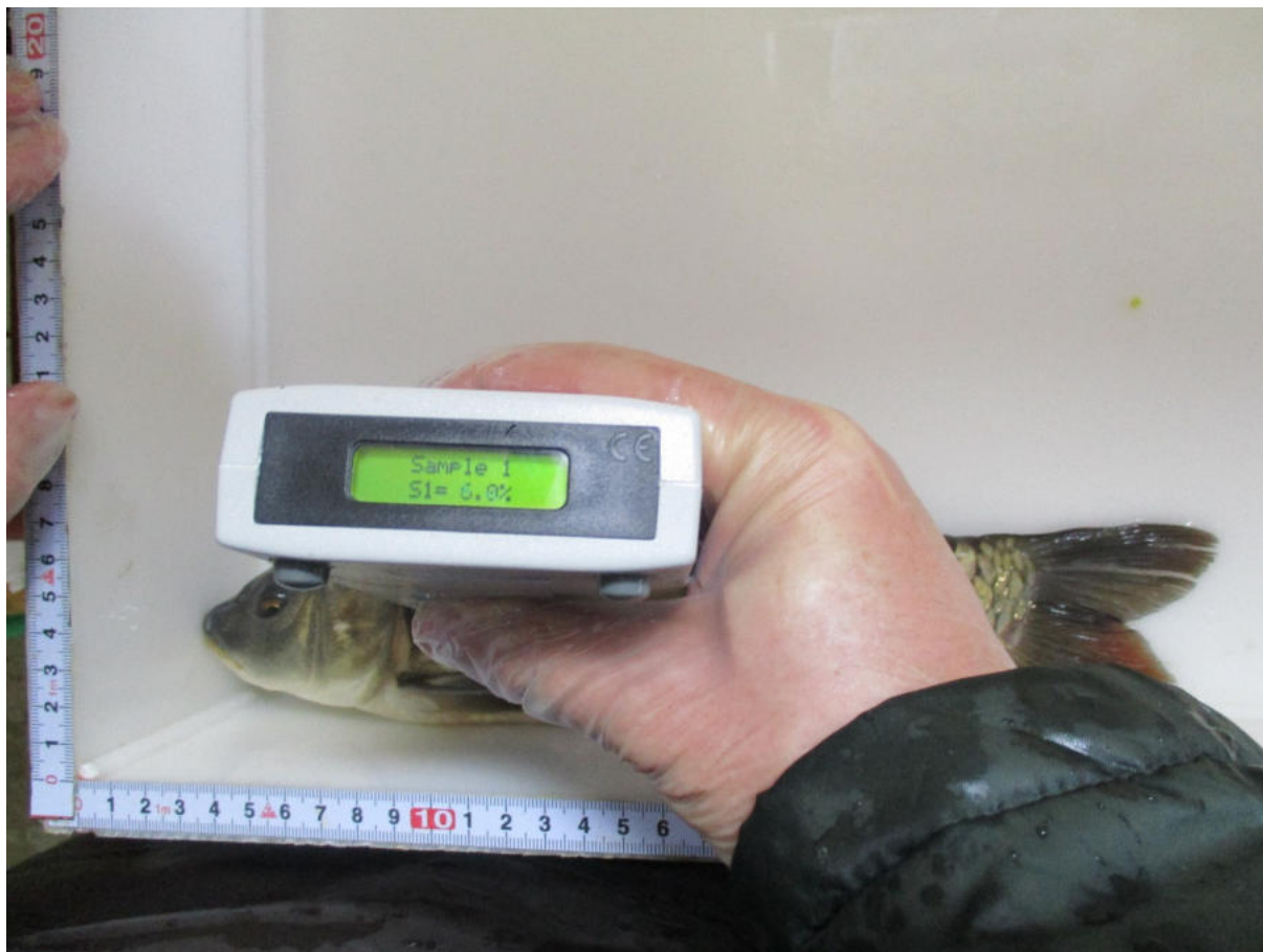
Obr. 7. Měření obsahu tuku ve svalovině amurského lysce s využitím tukoměru Fish Fatmeter FM 692. Foto: Martin Prchal
