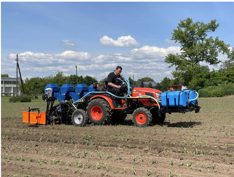
Foto 32: Ukázka setí podsevů multifunkčním testovacím strojem P & L
