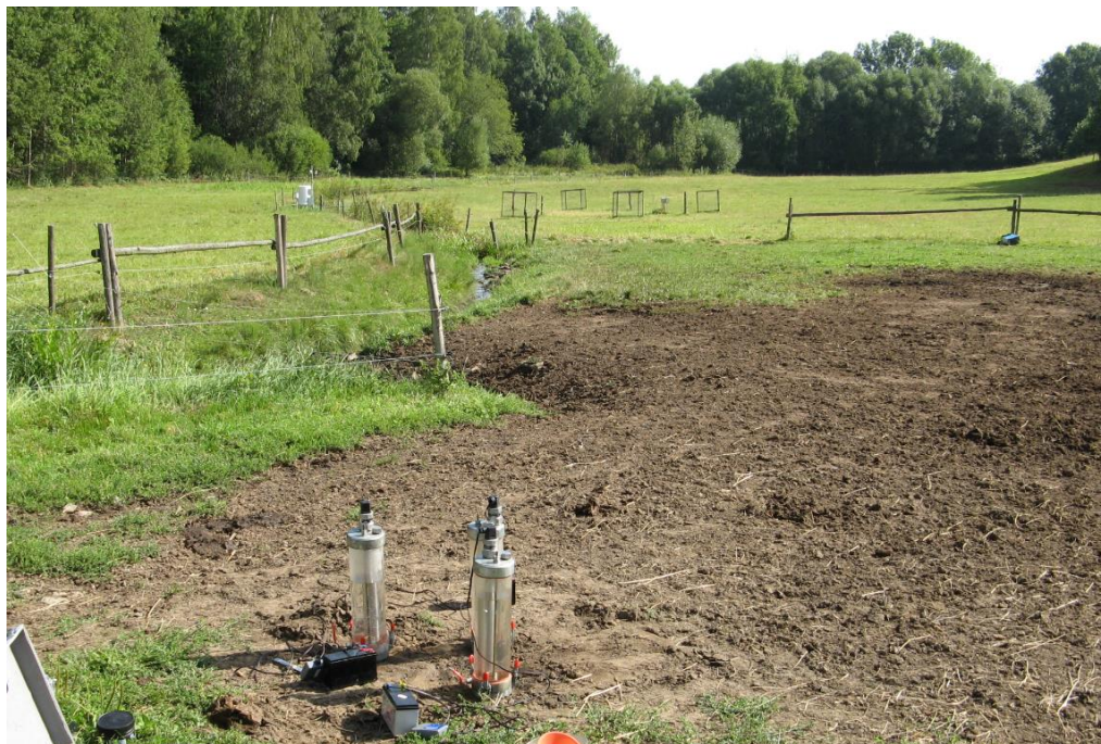
Obr. 2.3.4.1. Intenzivně sešlapaná lokalita ( hotspot ) poblíž napajedla, spojené s místem vyústění drenáže. V popředí měření přetlakovými infiltrometry. Foto: A. Zajíček
