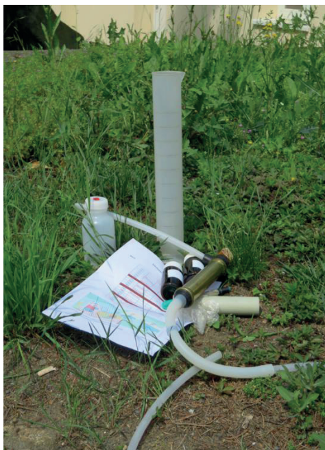
Obr. 7. Maloplošný drenážní plastový lyzimetr se skleněnou sběrnou nádobou pro odběr pesticidů (vlevo) a pomůcky pro odběr lyzimetrických vod v terénu (vpravo)
