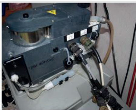
připojení čidel zákalu a vodivosti do vzorkovače
