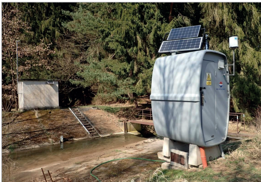
Obr. 16. Automatická vzorkovací stanice – Leský mlýn
