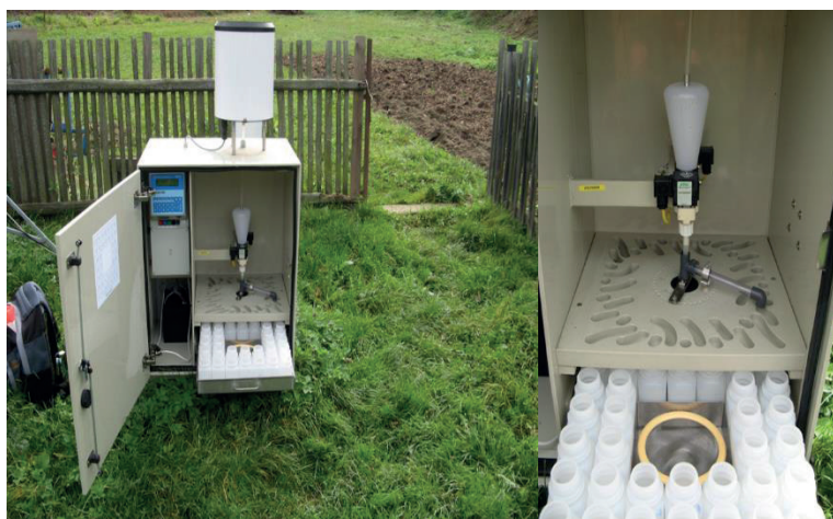
Obr. 11. Automatický vzorkovač srážek (patent VÚMOP, v.v.i.)
