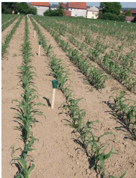
Obr. 8. Sukční kelímek s vaku-pumpičkou (vlevo) a pohled na sukční kelímky instalované na pokusné lokalitě (vpravo)
