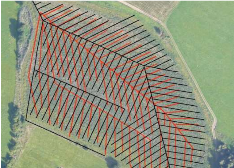
Obr. 3: Projektová dokumentace zemědělského odvodnění (černé linie) x skutečný stav realizace drenážní stavby (červené linie)
