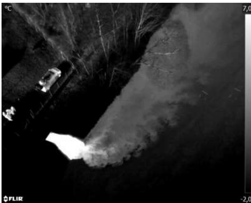
Obr. 9: Termogram ve škále odstínu šedi nad výstří z AČOV Tábor z výšky 50 m nad povrchem.
