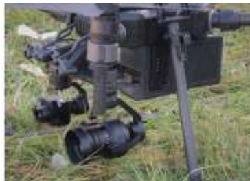
Obr. 14: Využitá aparatura pro termografické snímkování bezpilotním letounem (DJI Matrice 210 – RTK, termografická kamera DJI Zenmuse XT a stabilizovaná optická kamera DJI X5S).
