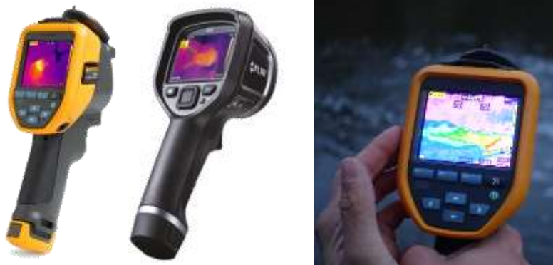
Obr. 15: V levé části obrázku jsou testované termální snímače FLUKE - TiS20 a FLIR E6. V Pravé části obrázku fotografie termální snímače při měření na výusti AČOV Tábora.
