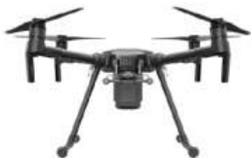
Obr. 14: Využitá aparatura pro termografické snímkování bezpilotním letounem (DJI Matrice 210 – RTK, termografická kamera DJI Zenmuse XT a stabilizovaná optická kamera DJI X5S).
