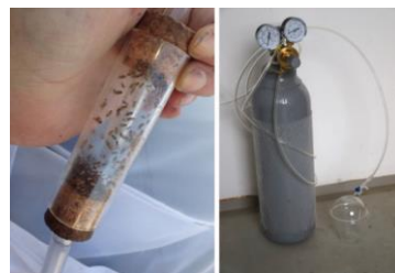
Obr. 17 K odchytu octomilek se používá exhaustor (vlevo). K imobilizaci imag se použije CO 2 , přiváděný hadičkou z tlakové bomby do exhaustoru.
