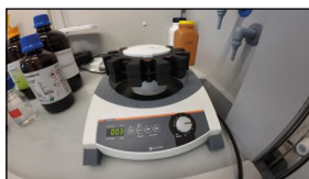
rozpuštění odparku v 1 ml 0,1% kyseliny octové, třepání (3 min)
