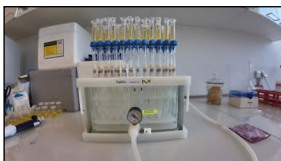
kondicionace MIP kolonek (2 ml acetonitrilu, 1 ml vody) následovaná prosátím 5 ml filtrátu
