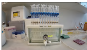
čištění MIP kolonek 4 ml 0,1% kyseliny octové, 4 ml vody a 500 μl diethyletheru
