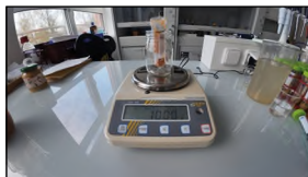
10 g vzorku + 130 μl pektinázy + 10 ml vody, inkubace (21±0,5 °C, přes noc)
