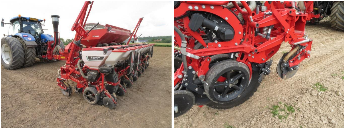
Obrázek 1 Secí stroj Kverneland Optima s technologií přihnojování Pudama. (foto Kroulík)
