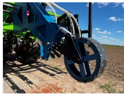
Obr. II.8 – Pohled na hutní kolo s výkyvným pohybem a konstantním přitlakem (ozn. těž
