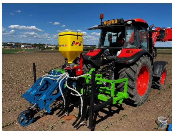
Obr. II.1 – modifikovaný funkční vzorek v roce 2024 s výslednými parametry prototypu (viz modré hrázkovací sekce)
