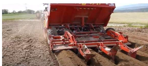
Obr. I.13 – Sazení brambor včetně důlkování pomocí strojů od firmy Grimme (dole), vlevo nahoře – obnova hrůbků a obnova hrázků of firmy Grimme (dole)
