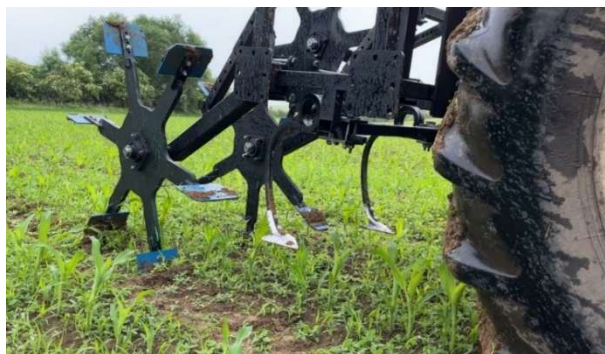
Obr. II.10 – Vyrobený hvězdicovitý stroj - systém důlkování
