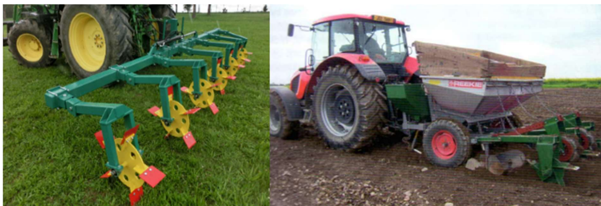
Obr.I.21 - Prototyp samostatné důlkovací plečky – KOVO NOVÁK+VÚZT+VÚBHB, ( https://www.kovonovak.com/agr/protierozni-hrazkovac/ ) a Prototyp důlkovacího adaptéru na sazeči brambor – VÚZT
