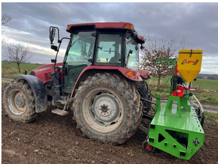
Obr. II.3 – ověřování kvality práce vyrobeného prototypu stroje (HPS4R) pro čtyřřádkovou technologii pěstování kukuřice (Vražkov)
