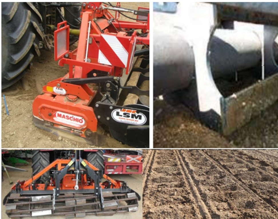
Obr.1.17- „ERuiStop“ přídavné zařízení přichycené za rotavátorem pro vytváření mikrozábran pomocí důkování vyráběný společností LSM (Jurbise, Belgie) - snížení odtoku vody a eroze půdy na kukuřičných polích Zdroj: Sittig, Sur, Baets, & Hammel, 2020 (základní rozměry vytvořených důlků obdélníkový tvar 40 x 20 cm, hloubku 12 cm, vzdálenost 15 cm podél brázd
