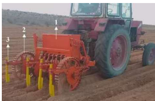
Obr. I.16 – Hrázkovací stroj v systému pěstování brambor - Egypt (Zdroj: Emara, Meselhy, Ashour, & El-Haddad (2023))
