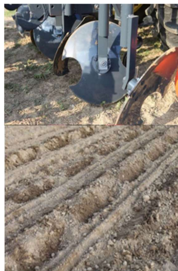
Obr.1.19 - důlkování pomocí vkrojených talířů s pasivním pohonem od firmy LSM, zdroj - Sittig, Sur, Baets, & Hammel, 2022
