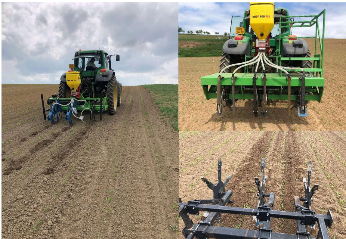
Obr. III.11 - Testování prototypu hrázkovacího stroje v roce 2024 a v roce 2025 a hvězdicový aplikátor v roce 2025
