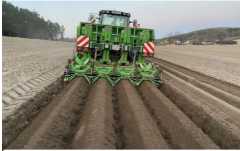
Obr.1.07- Řešení důlkování pomocí stroje AVR společně se sázením brambor
