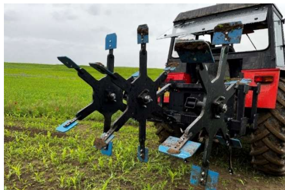
Obr. II.11 – Zadní pohled hvězdicovitý systém důlkování (Chotětov) dláta šířky – 60, 80, 140
