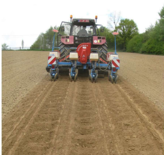
Obr.1.18- „ERuiStop“ výsledné řešení zařízení pro vytváření mikrozábran pomocí důkování vyráběný společností LSM (Jurbise, Belgie) s přídavným secím strojem širokořádkové plodiny- pracovní vytváření důlkování se současným setím hlavní plodiny zdroj - Consideration of risk management practices in regulatory risk assessments: evaluation of field trials with micro-dams to reduce pesticide transport via surface runoff and soil erosion, 2020, Stephan Sittig1* , Robin Sur2 , Dirk Baets3 and Klaus Hammel2
