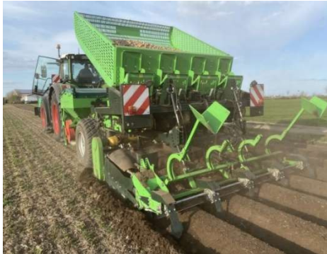
Obr.1.09 – Hrázkovací mechanismus na sazeči Ag-Vantage All in one
