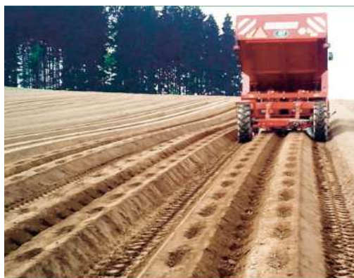
Obr. I.14 – Systém důlkování na hrůbku - PL Biskupice (zdroj. https://www.pal.cz/zemedelska-technika/stroje-na-brambory/p-l/modulator-hrubku )
