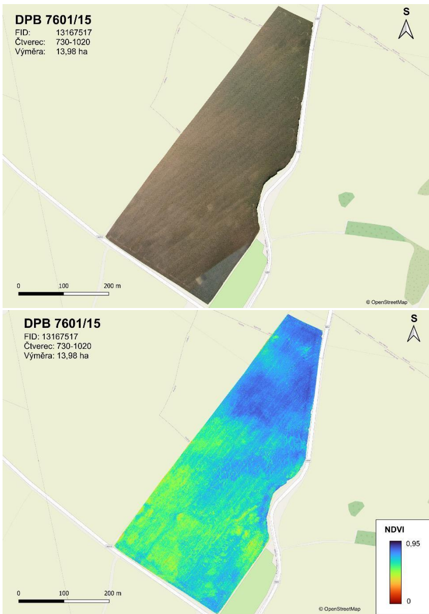
Obr. 14 RGB ortofotomosaika (nahore) a NDVI index (dole) z lokality Předboj
