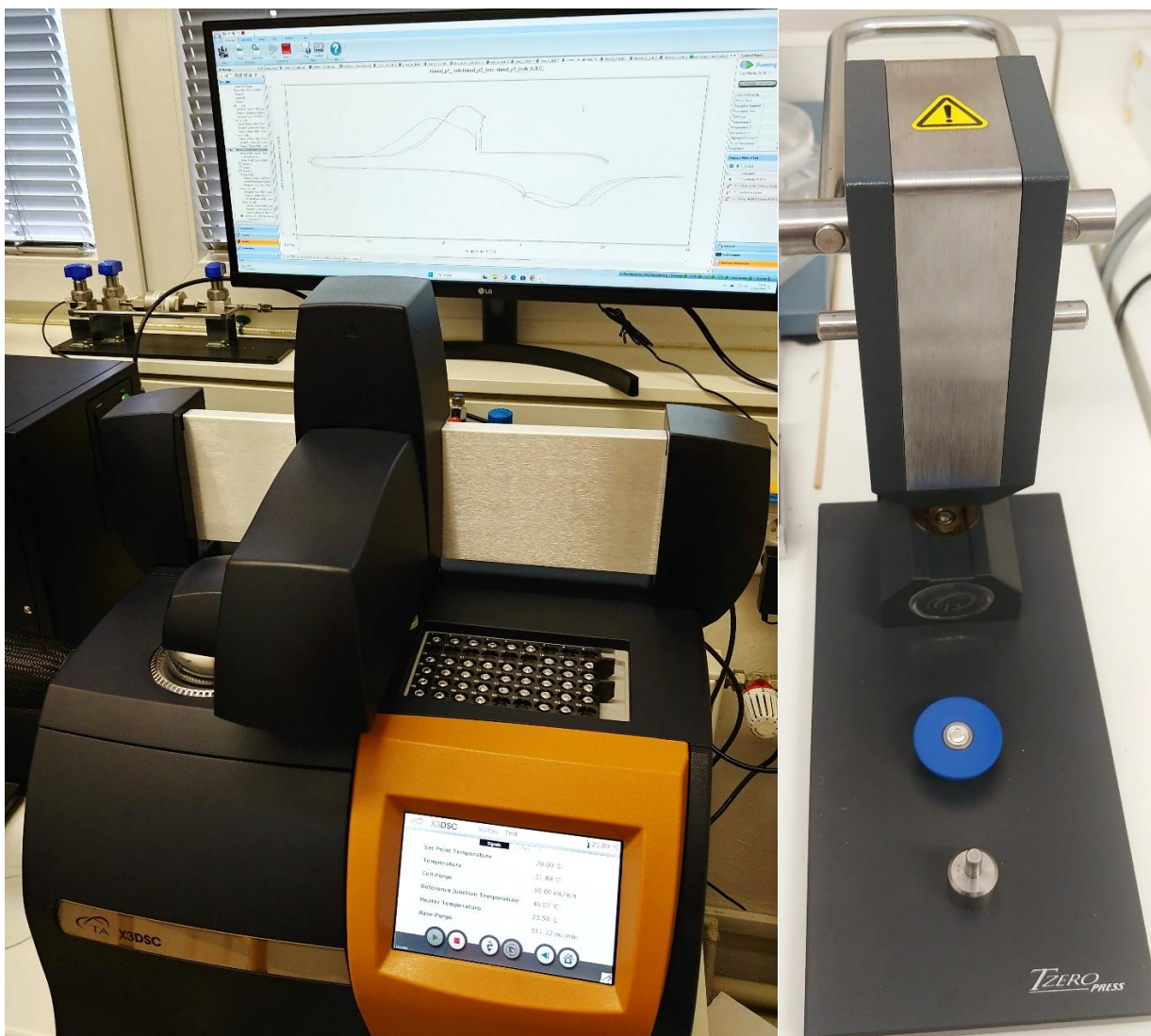
Obrázek 3. Diferenční skenovací kalorimetr DSC Discovery X3, TA Instruments, USA, vlevo. Lis pro hermetické uzavření pánviček do DSC Tzero Press, TA Instruments, USA, se zalisovanou pánvičkou v distančním přípravku (modrý) vpravo.
