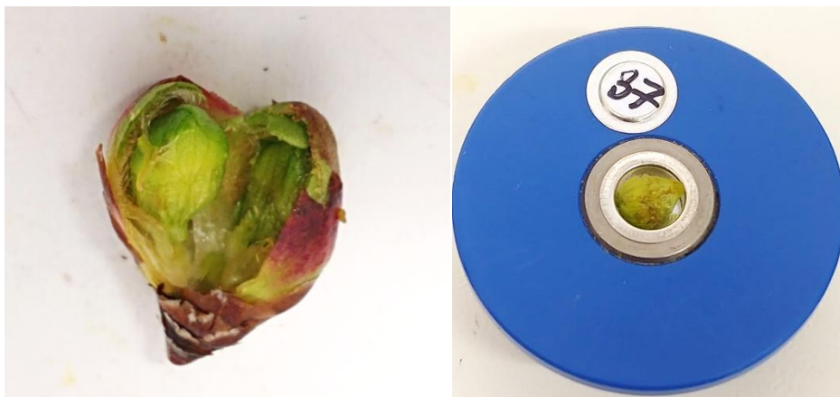
Obrázek 5. Květní pupeny třešně 16821. Připravené před termickým měřením, vlevo, vnitřní část květního pupene v 40 \mu\text{l} hermetické pánvičce před hermetickým uzavřením, vpravo.
