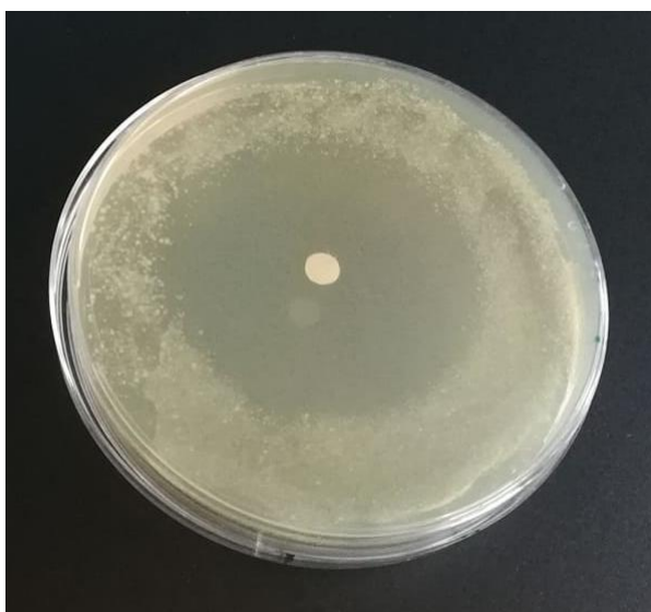
Obr. 6: ilustrační foto inhibice růstu bakterií Paenibacillus larvae působením vybrané rostlinné silice nanesené do středu misky (bílý terčík).
