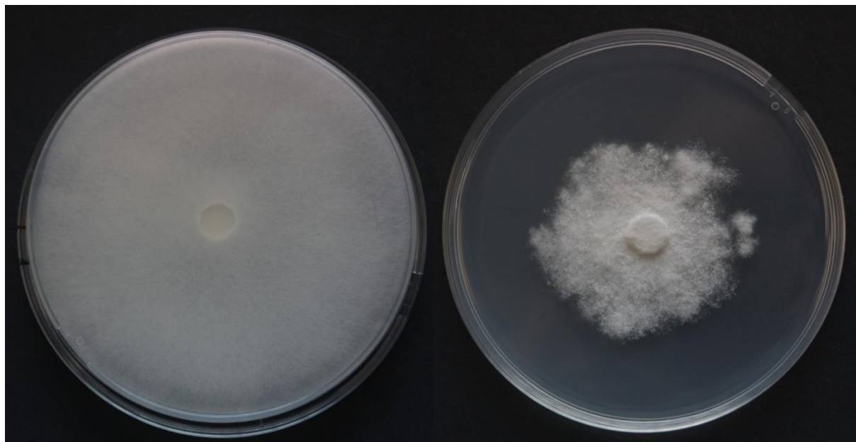
Obr. 5: ilustrační foto inhibice růstu mycelia patogena Ascosphaera apis působením vybrané rostlinné silice přidané do média (vpravo) v porovnání s kontrolní kulturou (vlevo).
