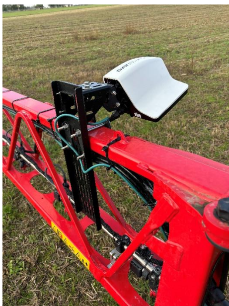
Obr. 10: Kamery DAT EcoPatch na ramenech postřikovače rozeznávají plevel a zajišťují optimální ošetření (foto Kroulík)
