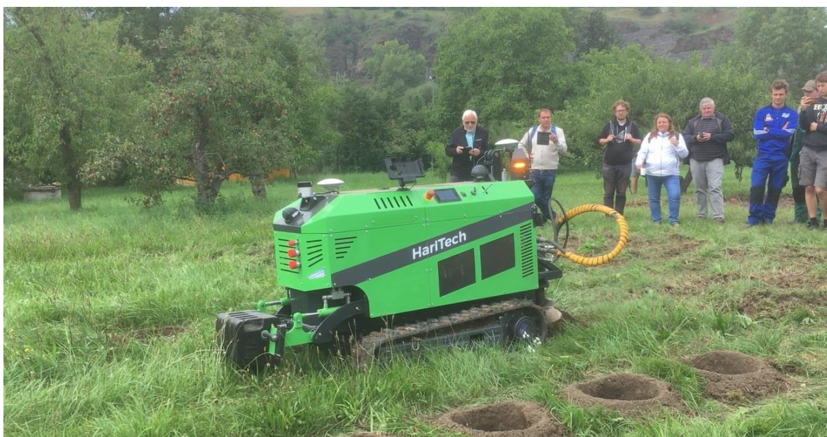
Obr. 5: Polní robot HariTech při zakládání jam pro opěrnou konstrukci (foto Kroulík).
