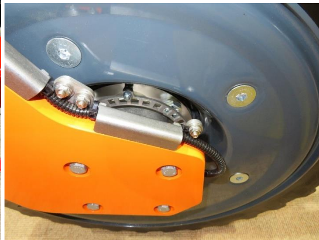
Obr. 15: Senzorové prvky osazené na kypřičích, které sledují ucpávání nářadí, případně jeho závady. Rovněž dokáží sledovat hloubku práce (foto Kroulík).
