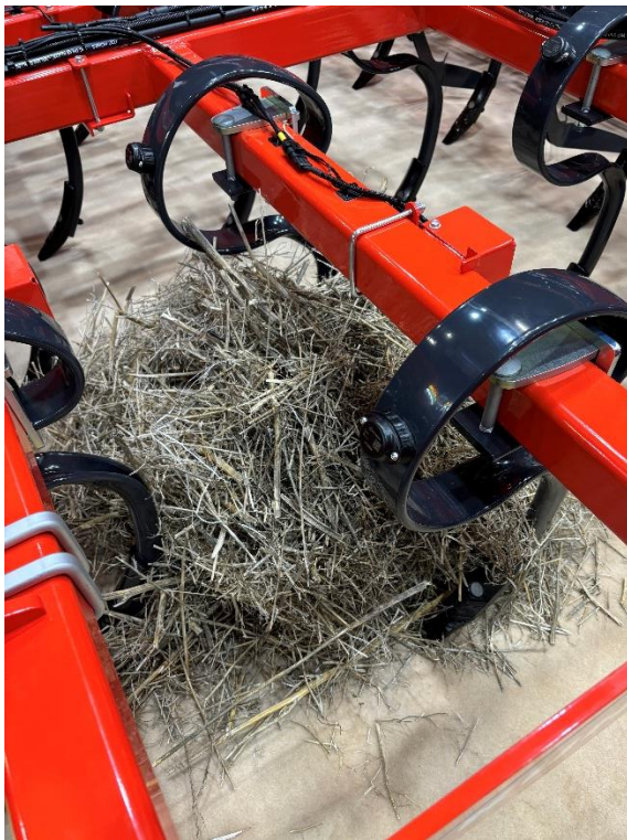
Obr. 15: Senzorové prvky osazené na kypřičích, které sledují ucpávání nářadí, případně jeho závady. Rovněž dokáží sledovat hloubku práce (foto Kroulík).
