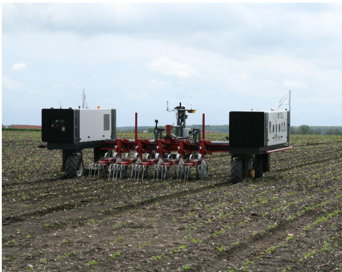
Obr. 1: Polní robot AgroIntelli Robotti při mechanickém plečkování (foto Kroulík).
