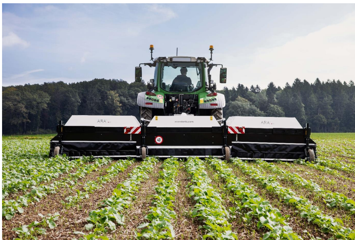
Obr. 9: Lokální aplikace herbicidů pomocí ARA Ecorobotics (foto LeadingFarmers, a.s.)
