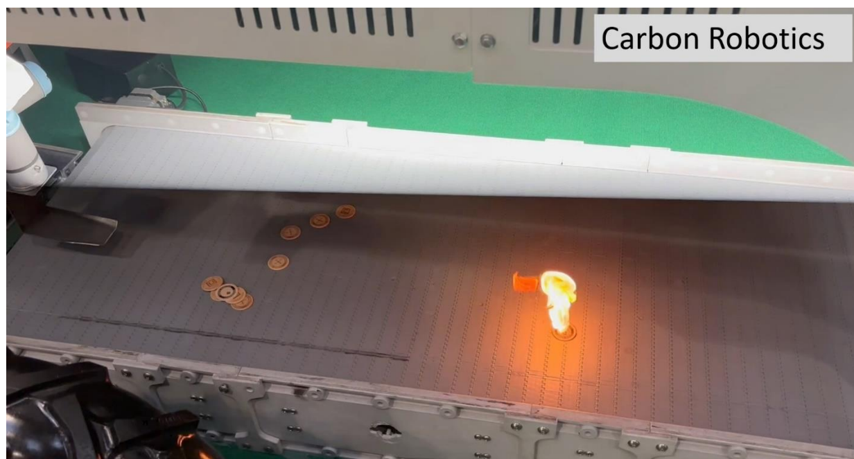
Obr. 12: Laserová technologie likvidace plevelů pomocí LaserWeeder, ukázka cíleného zásahu (foto Kroulík)
