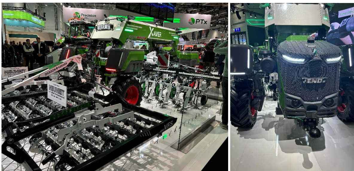
Obr. 16: Autonomní nosič nářadí vybavený závěsem pro připojení za traktor a potřebu převozu (foto Kroulík).
