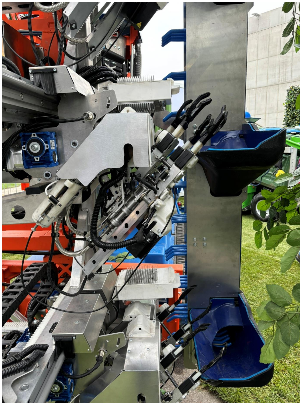
Obr. 7: Nástavba pro robotickou platformu Slopehelper, určená pro sklizeň jablek (foto Kroulík).
