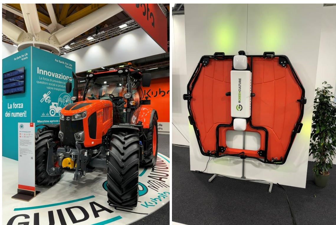
Obr. 13: Sada (automatizační kit), která umožní autonomní provoz traktoru. (Foto Kroulík).
